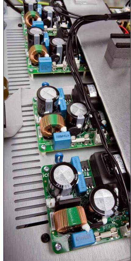
Vier Ice-Power-Module, davon zwei in Brückenbetrieb, versorgen die sechs Kanäle mit Leistung
