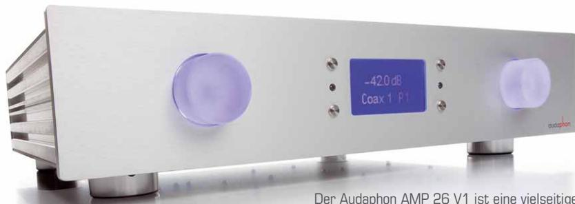
Der Audaphon AMP 26 V1 ist eine vielseitige Maschine mit DAC, Signalprozessor und Endverstärkung
